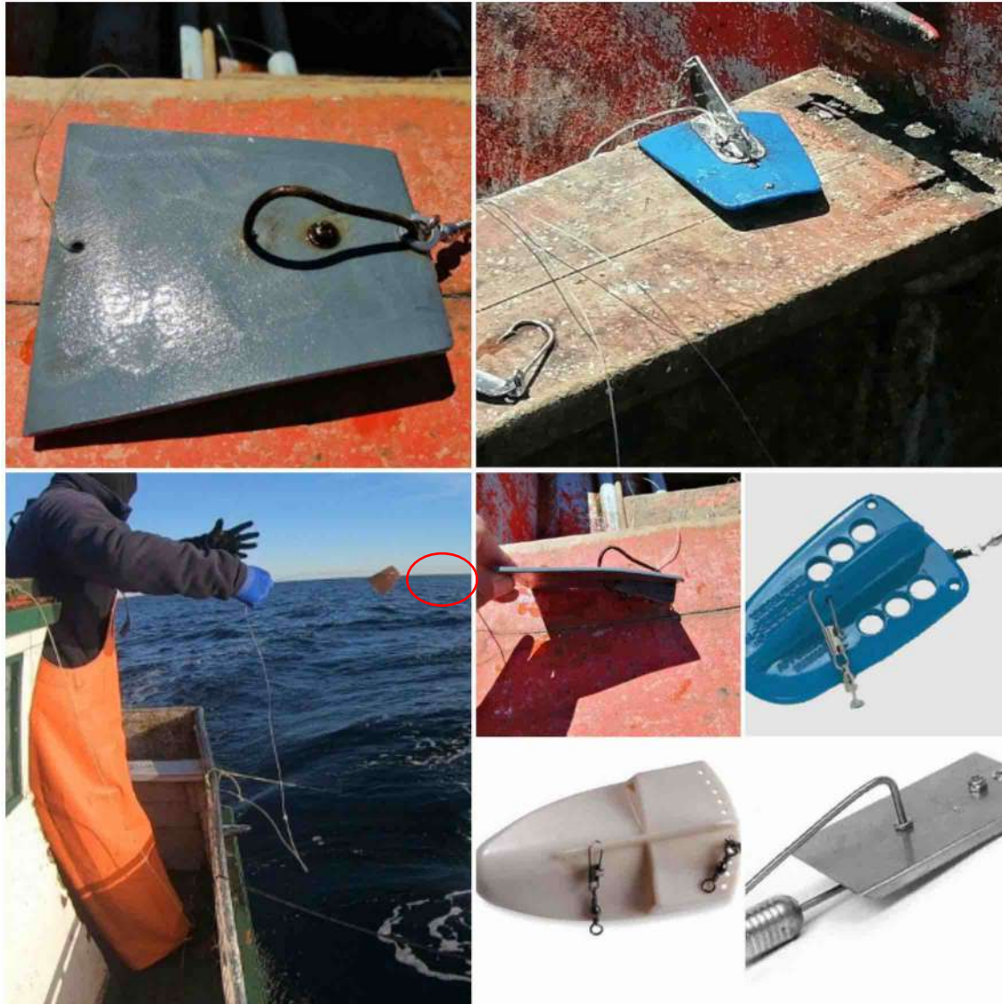
Figura 60. Tipos de profundizador, planeador, paraban o downdigger utilizados y comercializados por las tiendas de pesca.
